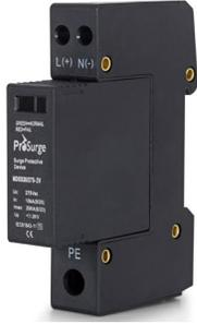
18mm 宽紧凑型设计, 可提供单相或者低压直流电源 (+、-) 的电涌保护, 节省安装空间。也可以组合使用, 根据需要组合成 36mm 宽的 4+0 或者 3+1 保护电路, 为三相电源供电设备提供电涌保护。
