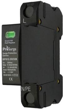
采用浦斯高能压敏电阻技术的薄型一类电涌保护器，产品宽度为 18 毫米，冲击电流泄放等级为 12.5kA (10/350 $\mu$ s)，满足 GB50057-2010 (建筑物防雷设计规范) 和 GB18802-12:2014 (SPD 使用导则) 等标准强制安装使用规定，适合于各类设施的电源主入口处或主配电柜中安装使用。
