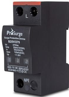
采用浦斯高能压敏电阻技术的一类电涌保护器，25kA 冲击电流 (10/350 $\mu$ s) 泄放等级，满足高度暴露且雷击频繁地区的雷电防御要求，适合于各类设施的电源主入口处、主配电分配电箱安装使用。
