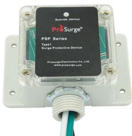
PSPE 是 PSP 系列中最小型的一款，适用于交流单相（或分相）供电的电气设备或系统的电涌保护。PSPE 具有 NEMA4X 等级防水箱体，标准 1/2 寸 NPT 管用密封螺纹接口，可用于室内外电子、电器设备就近安装保护使用或配电箱中安装。具有 LED 失效显示。
