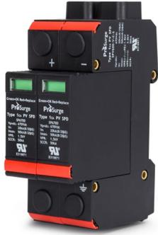
运用浦斯领先的热保护脱扣及主动灭弧专利技术 (TPAE)，产品具有优异的电涌保护功能和使用安全，取得 UL 实验室基于 UL1449 4th 标准的 Type1CA 类别的光伏 SPD 的认证，适用于光伏发电直流系统（逆变器直流侧）的电涌保护。产品提供底座一体式 U 型保护电路，用户可安装在光伏汇流箱、直流柜和逆变器等处，对逆变器、光伏电池板等直流设备进行有效的保护。
