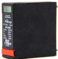
光伏保护模组运用浦斯领先的热保护脱扣及主动灭弧专利技术 (TPAE)，产品具有优异的电涌保护功能和使用安全，取得 UL 实验室基于 UL1449 4th 标准的光伏 Type1CA SPD 的认证。可作为光伏发电直流系统中各类电气设备内置电涌防护模块使用，配合 PVD 底座可实现印制电路板上装配。
